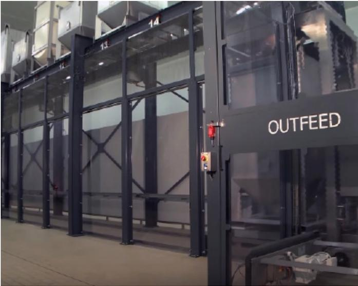
由“接料”料仓在支撑框架下方移动，根据不同的批次配方顺序接料。
