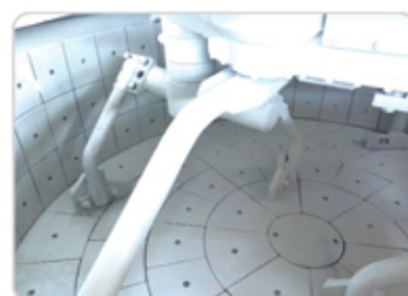
高铬合金铸造衬板 Cr-hard alloy cast iron liner
